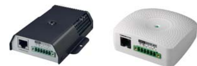
EMD (Dispositivo de monitoreo ambiental) para que pueda operar se necesita tener la SNMP instalada
